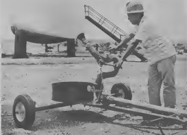
Serferino Ridderstap operates new mobile monitor nozzle. Serferino Ridderstap ta traha cu boquera di hoos nobo.
